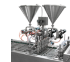
RDK (dosing units)
